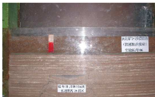
图 2 15 m 基岩保护层 Fig. 2 15 m bedrock protective coating
