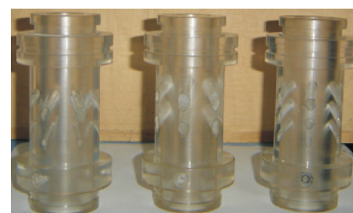
图 5 引射器照片 Fig. 5 Photograph of lead spurt instrument
