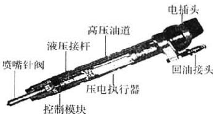
图 3 压电共轨喷油器
